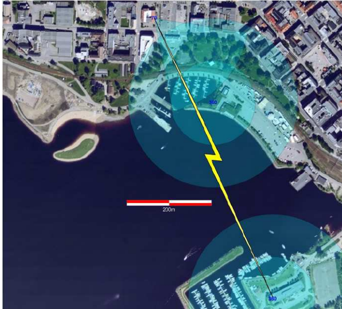
Figur: Hamar kommune har to radiosendere for bredbånd i sentrum, en på Hamar båtforenings hus på Tjuvholmen, og en på NAF-bygget ved Seaside. Disse er utstyrt med 360° antenner. I tillegg finnes det private sendere.
